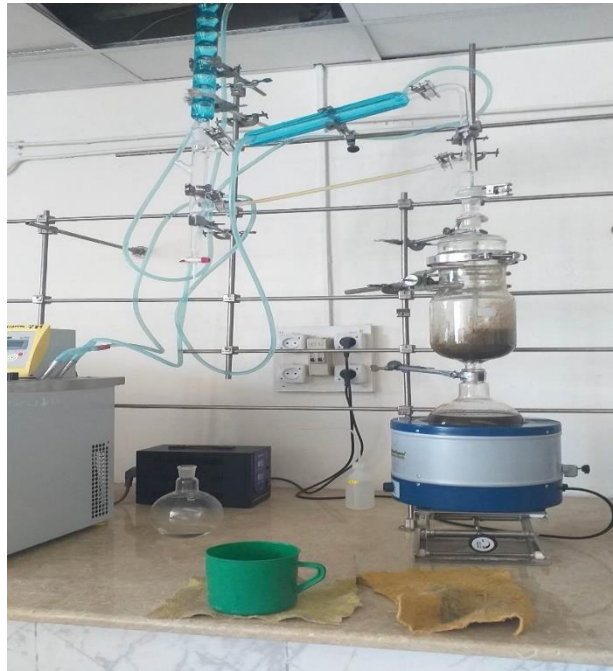
Figure 1. L'appareil d'extraction par distillation à la vapeur
